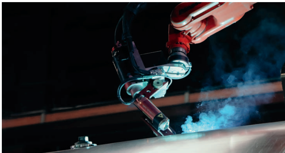
Associé à une cellule robotisée, le plug-in adaptatif Arc-Eye permet d'accroître la précision et l'efficacité de soudage, ainsi que de réduire le temps consacré à la programmation.
