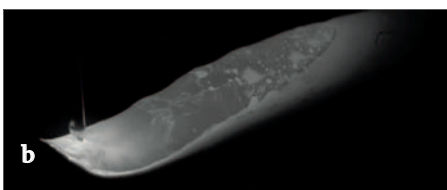
Exemples de visualisations optimales possibles à ce jour grâce à des caméras rapides et un éclairage laser. (a) Soudage laser ; (b) Fabrication additive WAAM ; (c) Découpe laser ; (d) Soudage arc fil.
