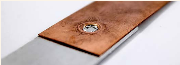
Assemblage aluminium/cuivre réalisé au moyen du procédé LPW (Locked Projection Welding).
