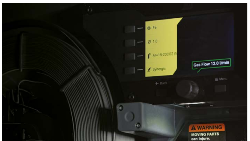
Figure 4. Dans ce système de soudage avec DGC, les utilisateurs règlent le débit de gaz dans le cadre d'une ligne synergique.
