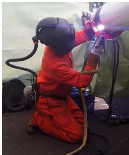
Figure 12 : Tuyauteur réalisant une soudure TIG en position verticale montante. Doc. IS [16]
