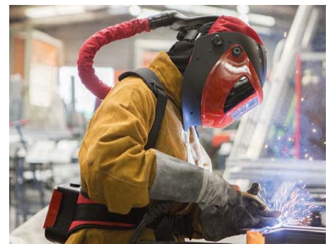
Figure 8 : Le soudage, tel qu'il était mis en œuvre dans les années 40 (ici à l'électrode enrobée) et de nos jours (cas du procédé MIG-MAG). Documents Flickr et Soudage Outillage, respectivement. [12,13]
