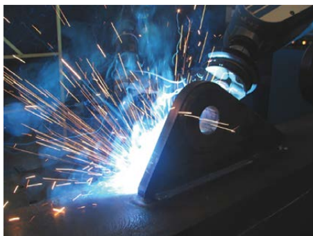
Figure 3 : Soudage MAG robotisé. On peut constater le lien projections/fumées. Doc. IS.
