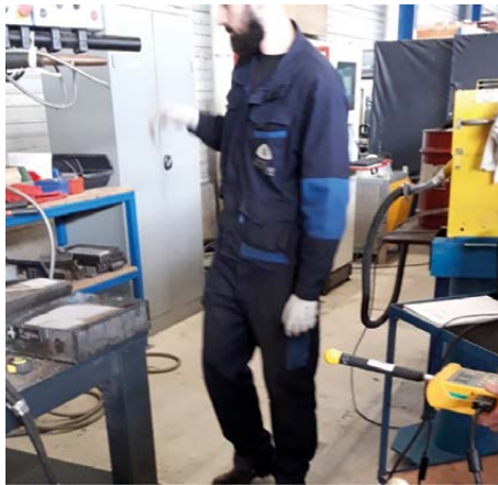
Figure 14 : Mesure en cours sur une machine de soudage sous flux en poudre. Doc. IS.
