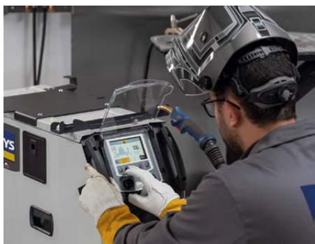
De technologie numérique, le Neopulse 400 G est un générateur MIG/MAG pulsé à dévidoir séparé. Intuitive et fonctionnelle, son interface numérique permet d'agir sur les paramètres de soudage en toute simplicité.
