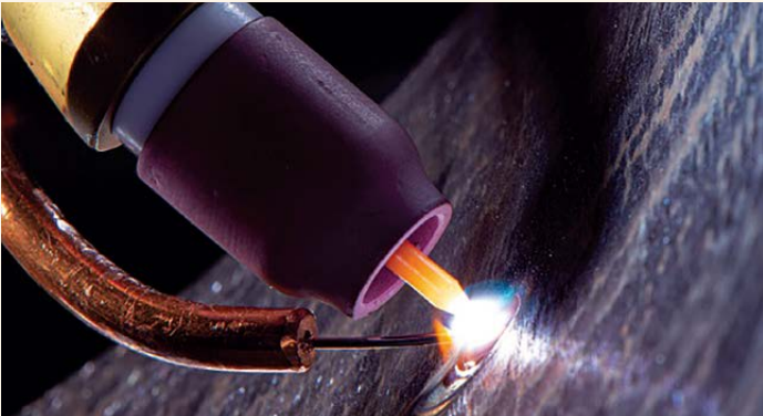
Rechargement par soudage TIG de l'alésage d'un tube.
