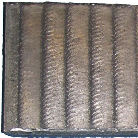
Figure 4 : Exemple de dépôt dur à base de carbures de tungstène (dimensions 100 x 100 mm). Procédé : PTA.
