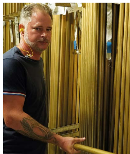
La production d'un chalumeau Le Lorrain démarre par des barres de matière première. Plus de 60 % de la barre finira en copeaux.
