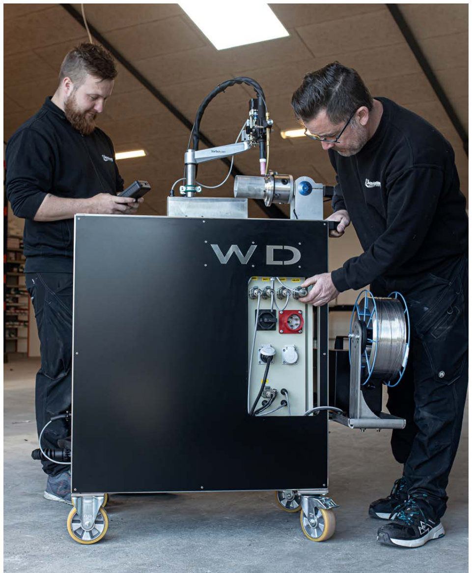
Idéal pour l'industrie pharmaceutique, le MiniDroid a été développé pour souder des tubes d'un diamètre de 6 à 120 mm et accessoires de petite taille.
