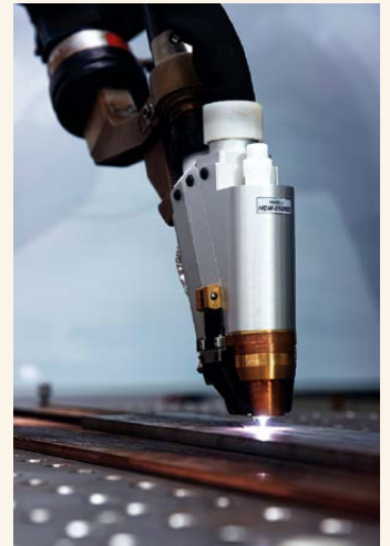
Le système SuperMIG du fabricant de matériel de soudage américain Weldobot, permet de tirer avantageusement parti de l'hybridation du soudage plasma et du soudage avec fil-électrode fusible.
